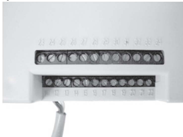
Figure 1: Bornes de commande du démarreur SMC-Flex
