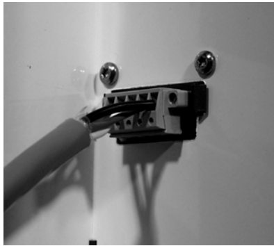
Conexión del cable de la unidad DeviceNet al puerto DeviceNet en la parte posterior del ducto de cableado vertical
